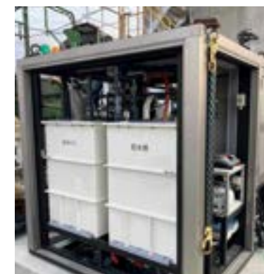
液体圧送装置 (3台)
